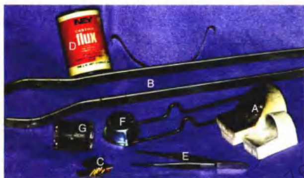
图22-24 铸造全部工具。A. 坩埚；B. 钳子；C. 铸造合金；D. 助焊剂；E. 镊子；F. 点火器；G. 铸圈
