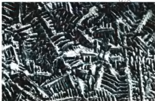
图26-3 镍-铬-钼-铝-铍合金电解蚀刻后的扫描电镜照片(1000倍),显示合金表面形成能被疏水性复合树脂润湿的凹坑状结构
