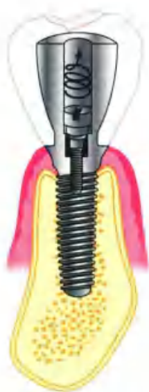
图 13-58 螺钉只有在连接处的分离力远大于夹持负荷时才会松动
