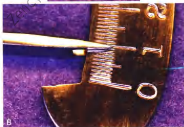
图 28-16 进行咬合调整（A）时，不断用卡尺测量剩余的厚度（B）。金属厚度小于 1.0 mm 是由于备牙时咬合空间不足导致的，此厚度会降低修复体的耐久性
