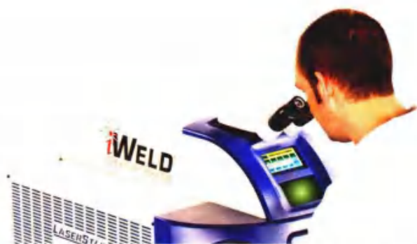
图 27-19 激光焊接。应用激光焊接连接钛修复体，可在高倍放大镜下监控焊接过程
