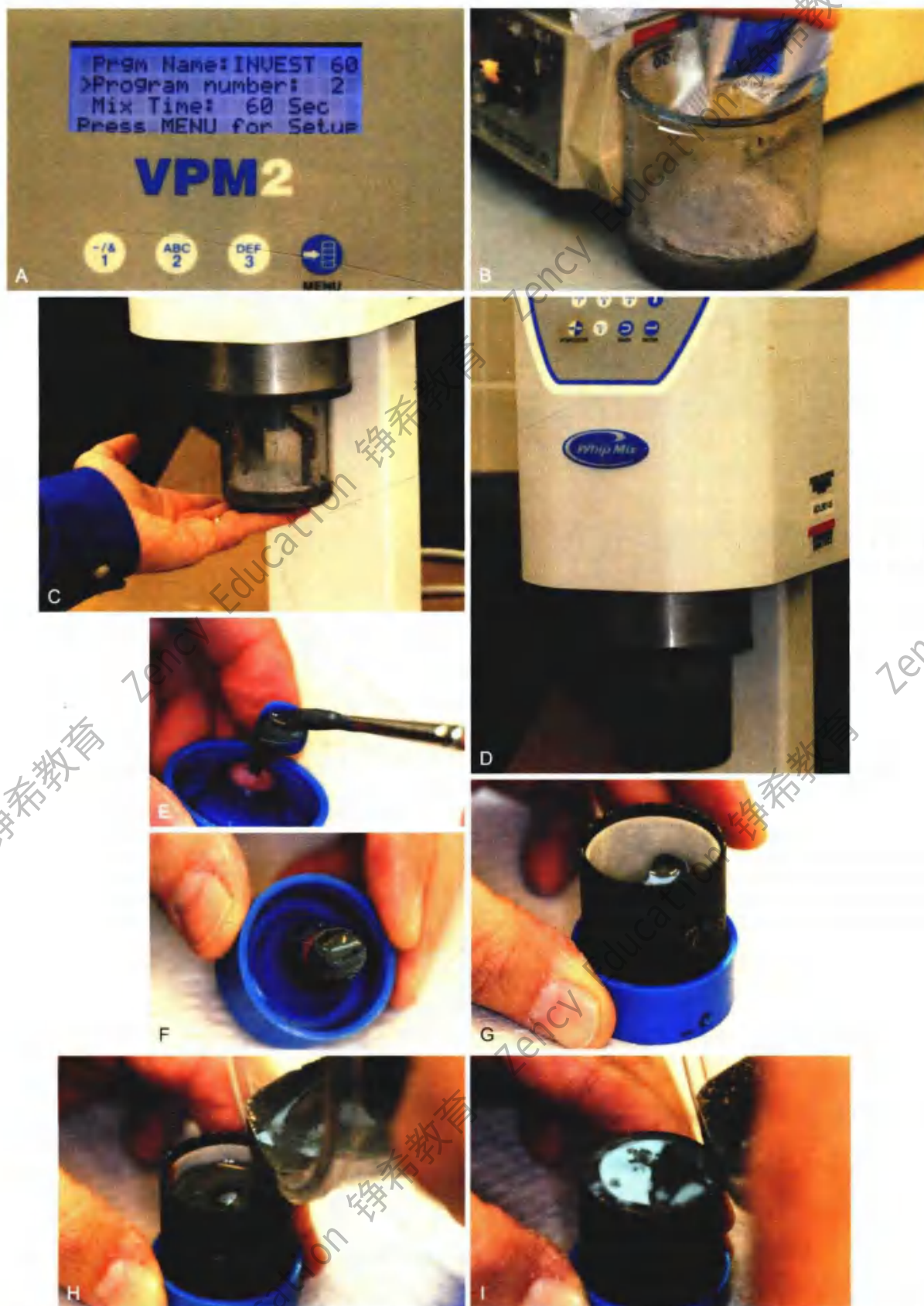
图 22-18 毛刷技术。包埋步骤：A. 在混合器上选择正确的程序；B. 向准确测量过的液体中加入包埋料；C. 混合碗的边缘插入真空混合机的凹槽中；D. 随着混合进行，碗被盖子和机器底部之间的真空固定住；E. 6 或 8 号刷子来包裹蜡型；F. 蜡型完全被包裹，此时可将铸圈连接底座；G. 带有内衬的铸圈和坩埚成型座连接；H. 振荡碗，将铸圈填满。当包埋料到达蜡型水平时，必须倾斜铸圈以降低空气进入蜡型的风险；I. 铸圈被完全填满
