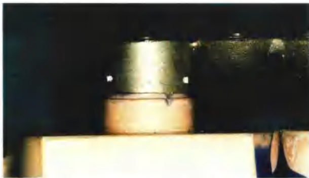
图 18-5 该实验中圆柱形铸件无法就位是因为包埋料的膨胀不足，而不是因为代型间隙不足
