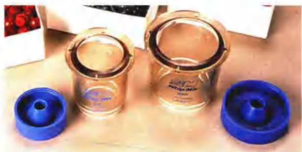
图 22-8 用于无圈包埋技术的成型座和圆锥形的塑料铸圈。坩埚成型座和塑料铸圈在去除蜡之前被去除，留下了被包埋的蜡型。该系统旨在实现包埋料的无限制膨胀（由 Whip Mix Corporation, Louisville, Kentucky 提供）
